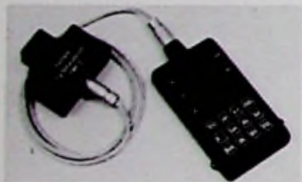
Bild 1: Nur 710 g wiegt das handliche Monitor-Farbmeßgerät THOMA TMF 2 von EMT
